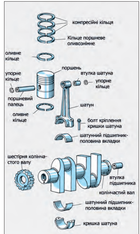
Рис. 113 Окремі частини кривошипно-шатунного механізму.
