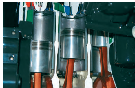
114-rasm. Porshenli dvigatelning to'la kesimi.
