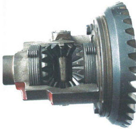
Abb. 202 Beim Selbstsperr-Differenzialgetriebe wird die Sperrwirkung durch Lamellenkupplungen hergestellt.
