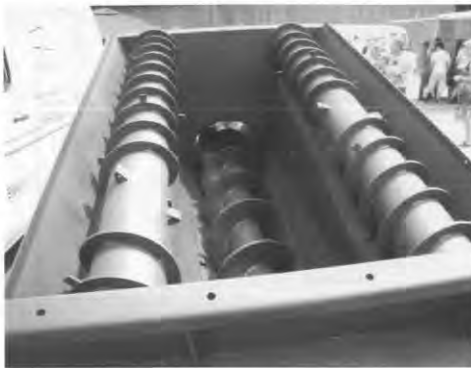
Abb. 1380 Feststoffdosierer zum Einbringen von Mist, Silagen oder Grüngut in dem Fermenter.
