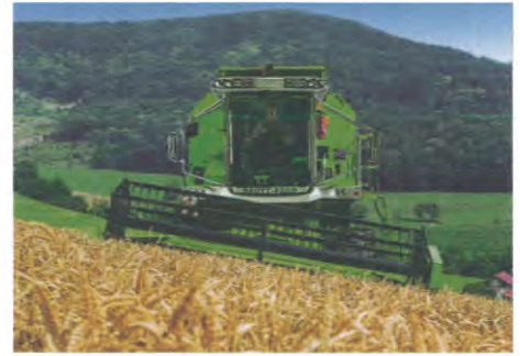
Abb. 128 Bei Mäharbeiten mit Hangausgleich bleiben die Schütler und Siebe bis zu 20 Grad Querhang waagrecht.
